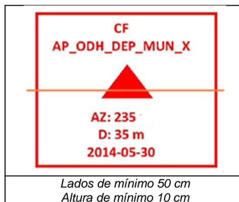
Figura 4. Ejemplo de Marcación de la cota fija permanente
