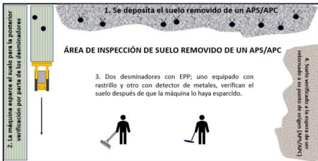
Figura 2. Procedimiento para la remoción del suelo con máquinas, Parte 2.
